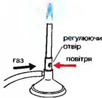
Пальник Бунзена Вміст повітря у газо-повітряній суміші регулюють поворотом кільця з отвором
